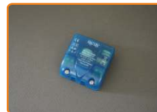
transformator LED 6W • wejście: 220-240V~50/60Hz • wyjście: 12V DC eff, 700mA • max obciążenie 6W • ochrona przed zwarcieniem
