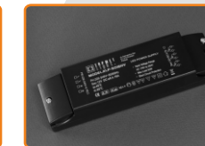
transformator LED 50W • wejście: 220-240V~50/60Hz • wyjście: 12V DC eff, 4.16A • max obciążenie 50W • ochrona przed zwarcieniem
